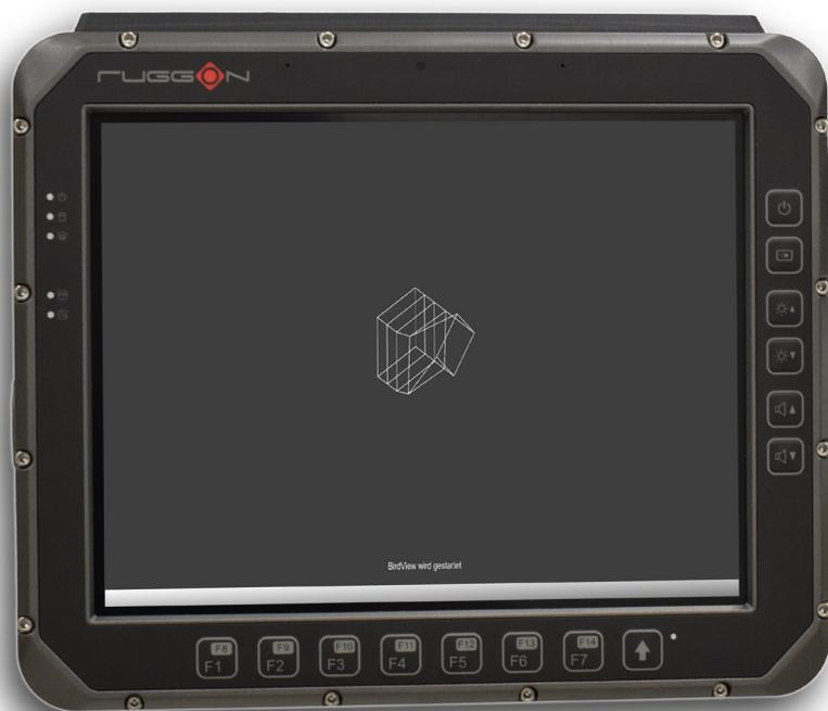
Terminale utente resistente da 10,4 pollici con touchscreen e modulo WiFi interno per gli aggiornamenti via aria. Con connessioni filettate M12 e pulsanti touchscreen nella parte inferiore dello schermo per un'operazione ancora più semplice.
